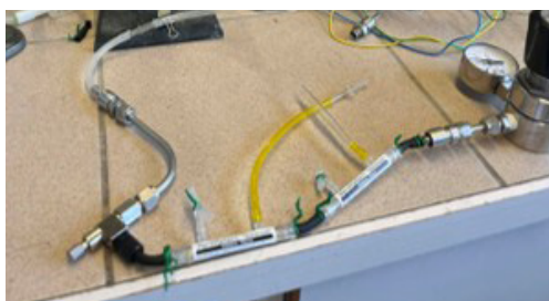
6. és 7. ábra: Kaszkádos membránmodul kivezető csomakkal
