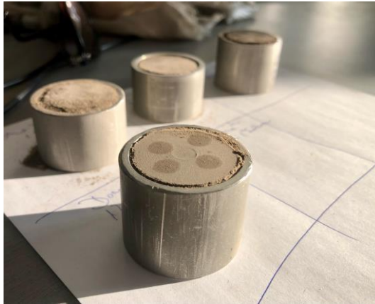
2. ábra. Pasztillás módszer (Domaszék minta cseppentés után)
