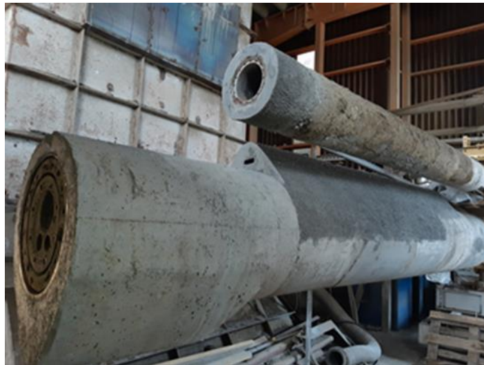
1. ábra. A klinkerégető kemence fő- és segédégője.
