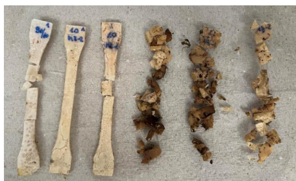
84. ábra Próbatestek enzimmentes környezetben történő komposztálást követően (balról jobbra: adalékmentes 90/10 összetételű, CO-140-MB mesterkeveréket tartalmazó 90/10 összetételű, CO-140-x-MB mesterkeveréket tartalmazó 90/10 összetételű, adalékmentes 50/50 összetételű, CO-140-MB mesterkeveréket tartalmazó 50/50 összetételű, CO-140-x-MB mesterkeveréket tartalmazó 50/50 összetételű PLA/kukoricakeményítő kompozit)
