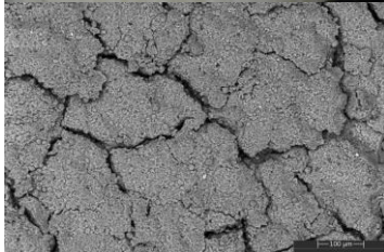
87. ábra 10% kukoricakeményítő tartalmú PLA kompozitokról készült fénymikroszkópos és SEM (250-szeres nagyítással) felvételei komposztálást követően enzim nélkül, lipázzal és amiláz keverékkel
