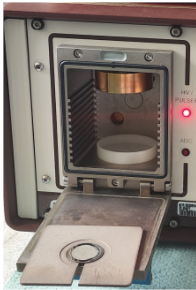
16. ábra: Alfa-forrás behelyezése a mérőeszközbe
