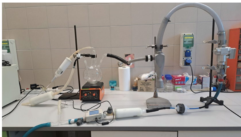
10. ábra: Reszuszpendált aeroszolak laboratóriumi mintaelőkészítése
