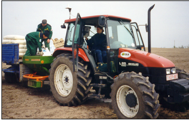
4.8.5. ábra: ACT-AMAZONE precíziós műtrágyaszóró rendszer Figure 4.8.5. ACT-AMAZONE precision fertiliser distributor system
