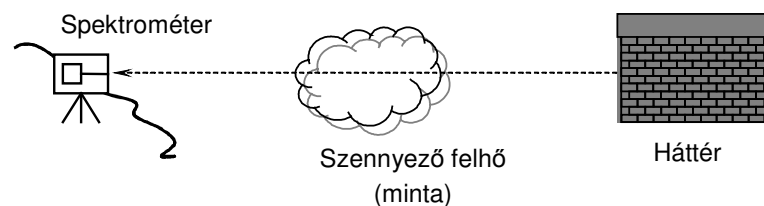
1.6. ábra: Passzív nyílt fényutas detektálás: a „fényforrás” a szennyező felhő mögött elhelyezkedő a detektornál magasabb hőmérsékletű objektum
