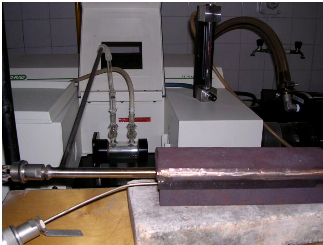
3.16. ábra: Katalizátor üzem közbeni folyamatos vizsgálata FTIR spektrométerrel
