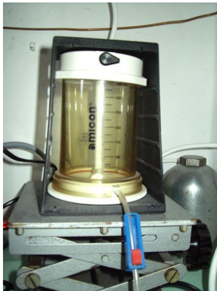
9. ábra Amicon cella az oldott szervesanyagok molekulaméret frakcionálásához
