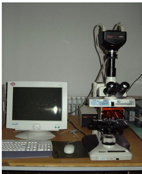
10. ábra Nikon Optiphot II. epifluoreszcens mikroszkóp
