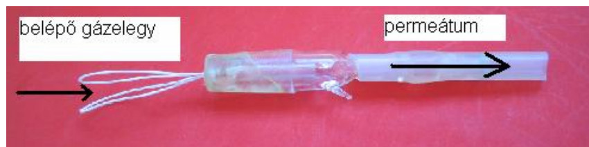
3-4. ábra. A pórusos membránmodul felépítése a gázáramokkal
