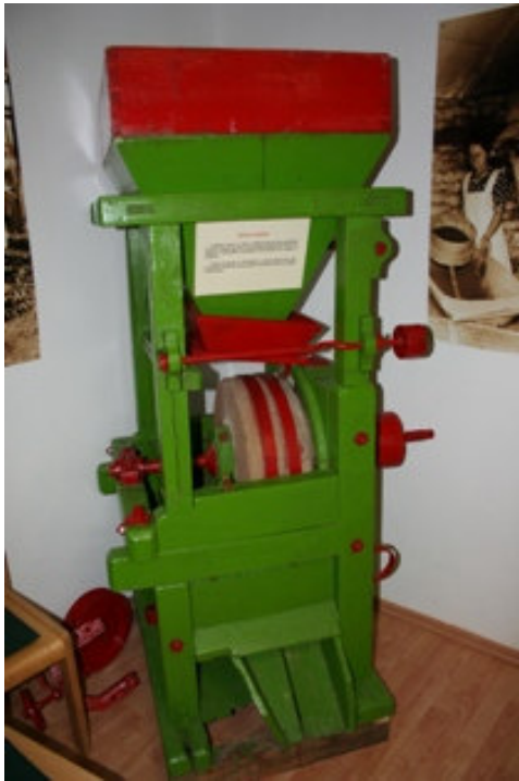
5. kép Függőleges elrendezésű, egy kőpáras malom
