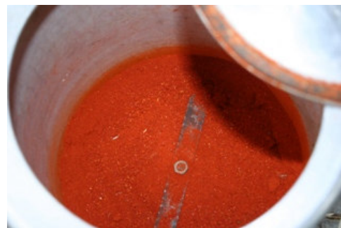
8. kép A házi daráló lelke a körben forgó fémfűrész-lap
