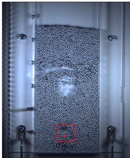
4.21. ábra. A kvázi kétdimenziós fluidágy megjelölve a kiemelt, modellezett térrészt és egy, a videofeldolgozás alapján felismert és követett golyót.
