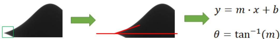
4.5. ábra A kontaktszög meghatározása mágneses térben
