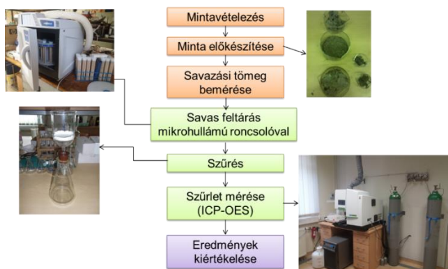
3. ábra Az üledékminták mérési módszere ICP-OES készülékkel
