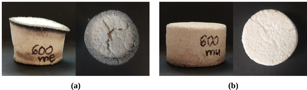
52. ábra Az N-4,5-0,1 jelű minta égetés után: a) nem mosott és b) mosott minta
