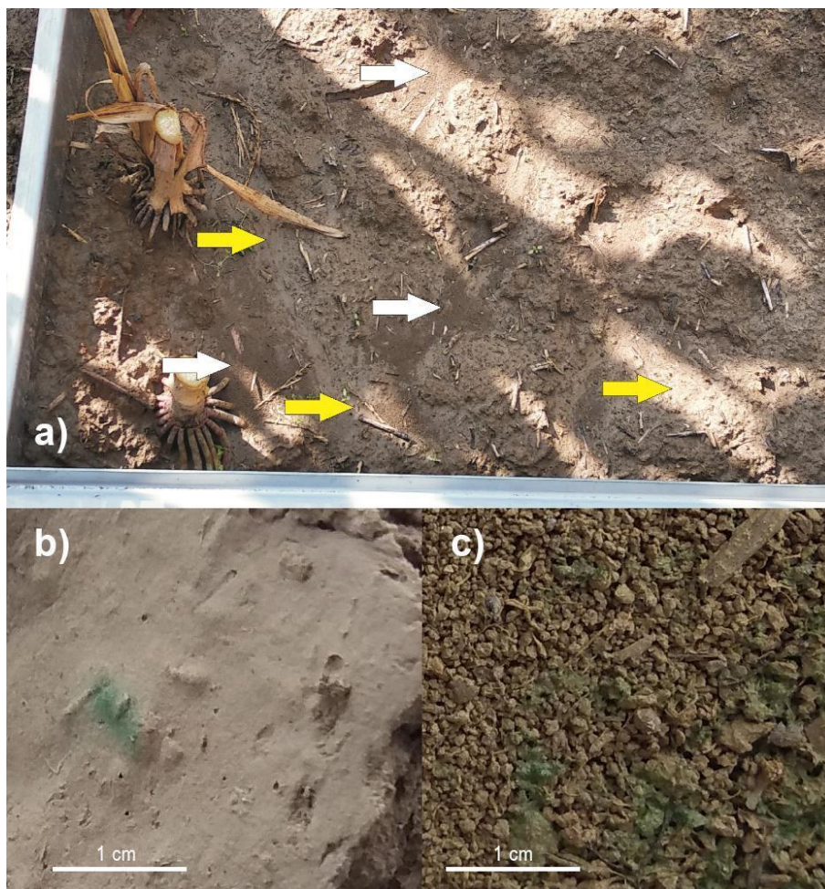
32. ábra A talajfelszín jellemzői esőzést követően: (a) a kezelt területen, ahol a fehér és sárga nyilak rendre az aggregált és az egyedi szemcsés üledékképződést jelzik; (b) aggregátumok nélküli talajfelszín a kontroll parcellán; (c) aggregátumok az algával kezelt parcellán. (Forrás: HUN-REN CSFKI)
