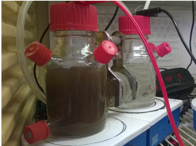
16. ábra Mikrobiális üzemanyagcella puffer oldattal feltöltve és inokulálva
