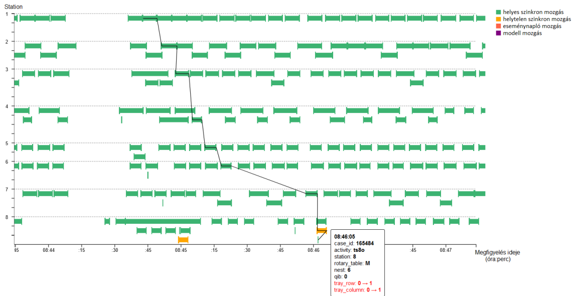
2.11. ábra. Egyetlen gyártási nap nyomvonalából származó igazítási adatok vizualizációja: a leggyakoribb eltérés
