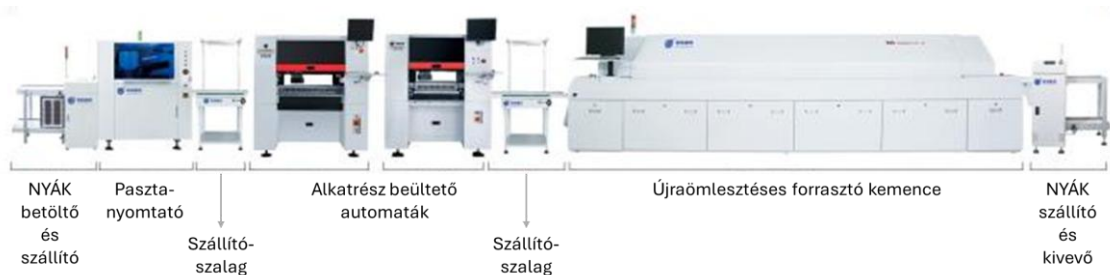
2.6. ábra: SMT gyártósor berendezései
