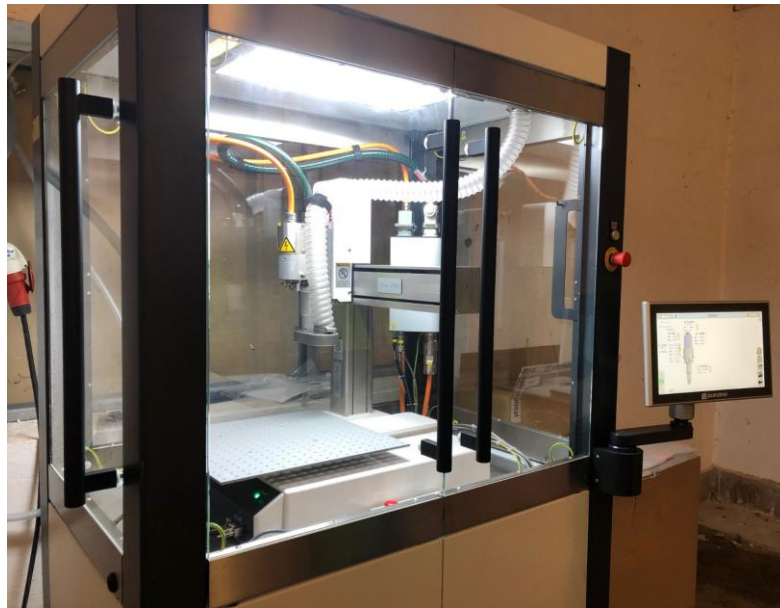
5.1. ábra: Plasmareat PTU1208 plazmagenerátor asztali robottal
