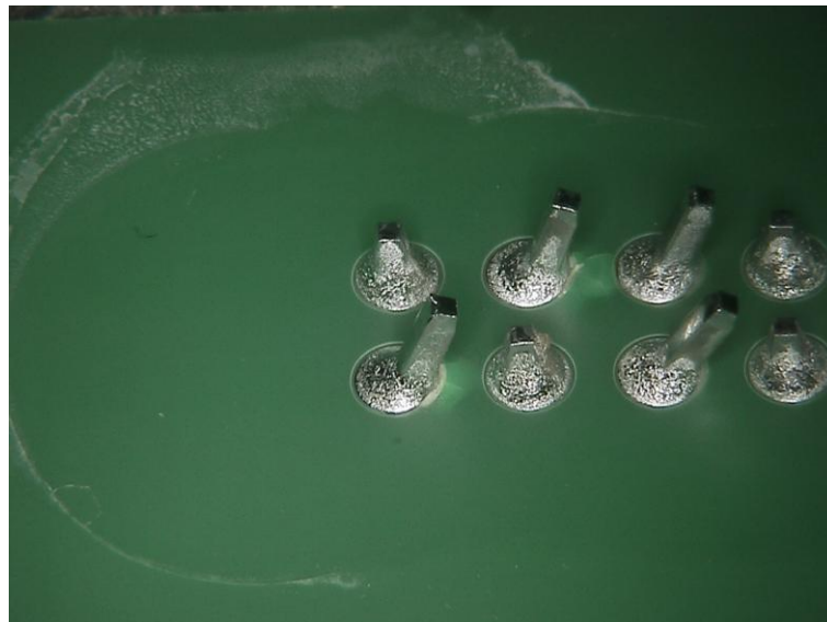
6.10. ábra: Fehér maradvány a furatszerelt csatlakozó környezetében
