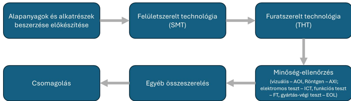
2.4. ábra: Elektronikai termékek gyártásának folyamatábrája
