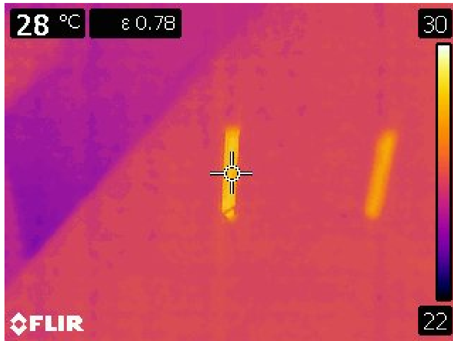
3.5. ábra. A tekercsek melegedésének ellenőrzése, hőkamerás felvétel
