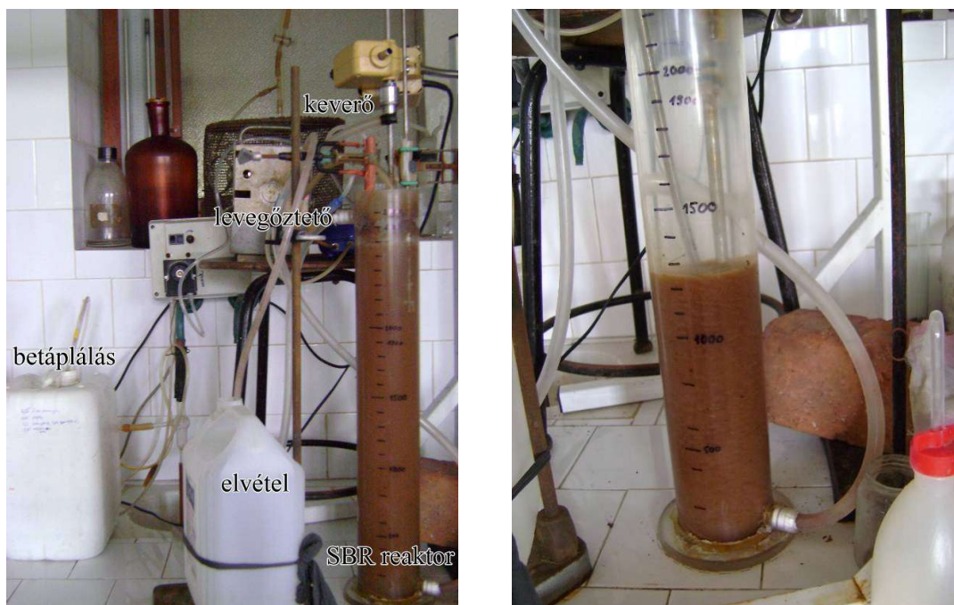
1. ábra A kísérleti reaktor levegőztetés (bal oldali kép) és ülepítés (jobb oldali kép) közben
