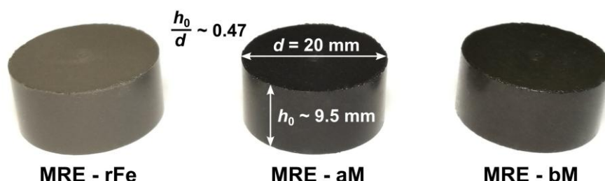
3.2. ábra. A különböző töltőanyagokkal készült minták: redukált vaspor (rFe), Sigma-Aldrich magnetit (aM) és Bayferrox 318M magnetit (bM) Az MRE-k mérete mindhárom töltőanyag esetében azonos volt.
