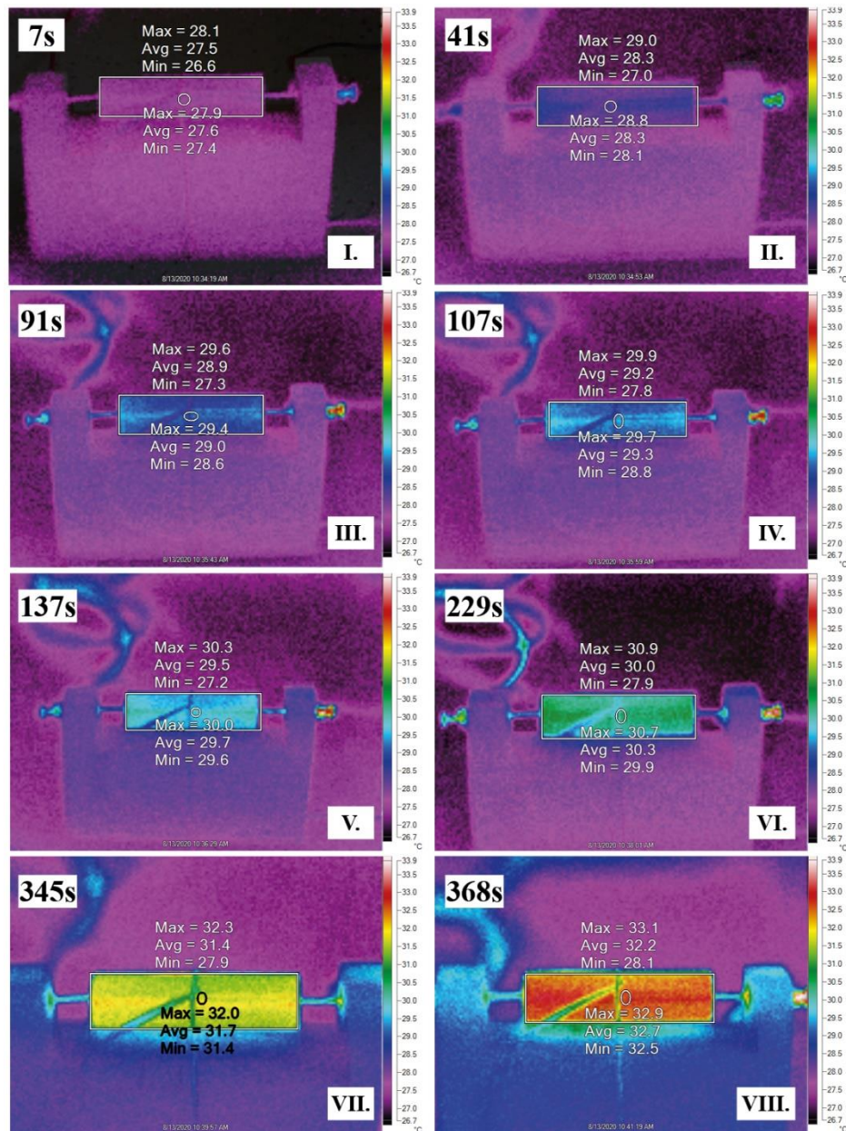
7-1. ábra Hőképek az akkumulátor elülső nézetéről. Az akkumulátort egy speciális akkumulátortartóba szereltük, amely minimalizálja a hőátadást az akkumulátorkapcsokon keresztül. A cella melletti forró pontok a tápkábeleket, azok kapcsait és a termoelem vezetékét mutatják. A hőmérsékleti adatokat °C-ban rögzítettük
